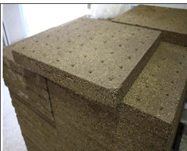
鋪設天面之基盤材
